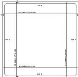
CX D'ÁGUA - ARMADURA - DO FUNDO ESCALA 1:50
