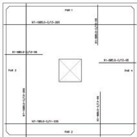
CX D'ÁGUA - ARMADURA - DA TAMPA ESCALA 1:50
